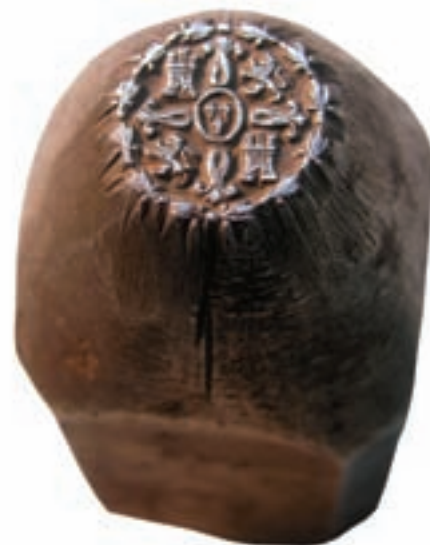
Mesa e instrumentos de un grabador (arriba) y un punzón tallado en acero para el reverso de la moneda de cobre de Segovia a partir de 1772 (abajo).
