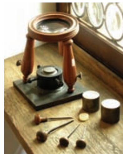
Mesa e instrumentos de un grabador (arriba) y un punzón tallado en acero para el reverso de la moneda de cobre de Segovia a partir de 1772 (abajo).
