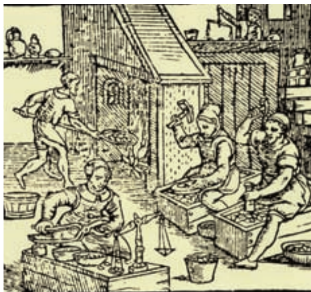
Grabado de un taller de acuñaación a martillo. Observamos el horno de recocimiento, el golpeado a martillo de las planchas de metal, el recortado de los cospeles con tijeras y la acuñaación a martillo.
