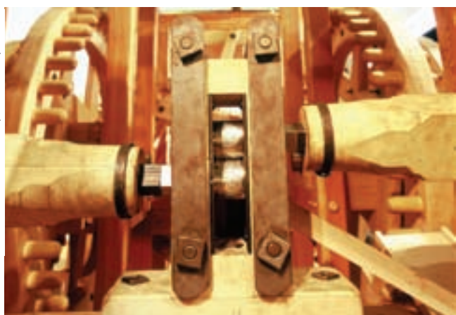
Reconstrucción a tamaño real de un ingenio de acuñar a rodillo en el Museo de la Casa de Moneda de Hall en Tirol. El artificio fue construido en 2003 por el maestro tornero Werner Nuding y se utiliza a diario para acuñar muestras para los visitantes.
