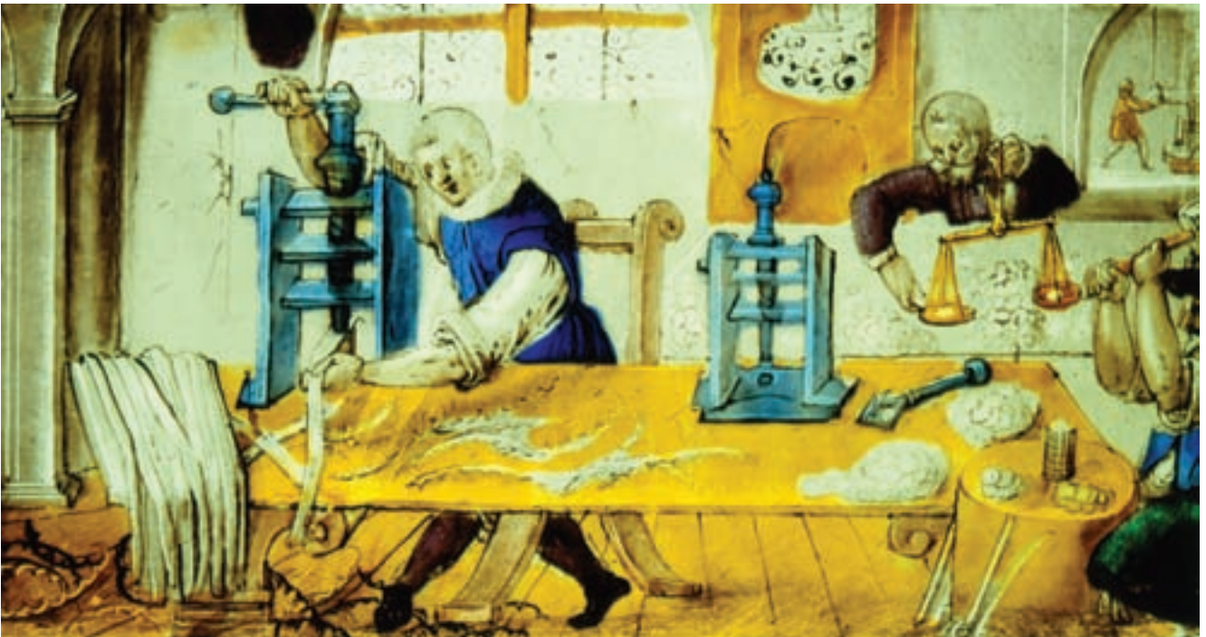
Departamento del recortado de cospeles en una ceca mecanizada con prensas de volante según la vidriera Konstanz , de 1624. A la izda. observamos rieles de plata sin recortar y un operario recortando cospeles en un tórculo grande. Al lado del tórculo pequeño vemos el brazo giratorio desmontado y varios montoncitos de cospeles ya recortados con el balanzario verificando que el peso de las piezas iba saliendo bien.
