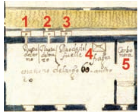
Detalle del plano de 1678 en el que se ve el departamento de herrería con sus tres ruedas hidráulicas -rueda del torno (1), rueda del mazo (2), y rueda del fuelle (3)-, así como la fragua (4) y la carbonera (5), y fotografía de los agujeros de los ejes de las mismas ruedas, y el asentamiento del mazo, en la obra de rehabilitación.
