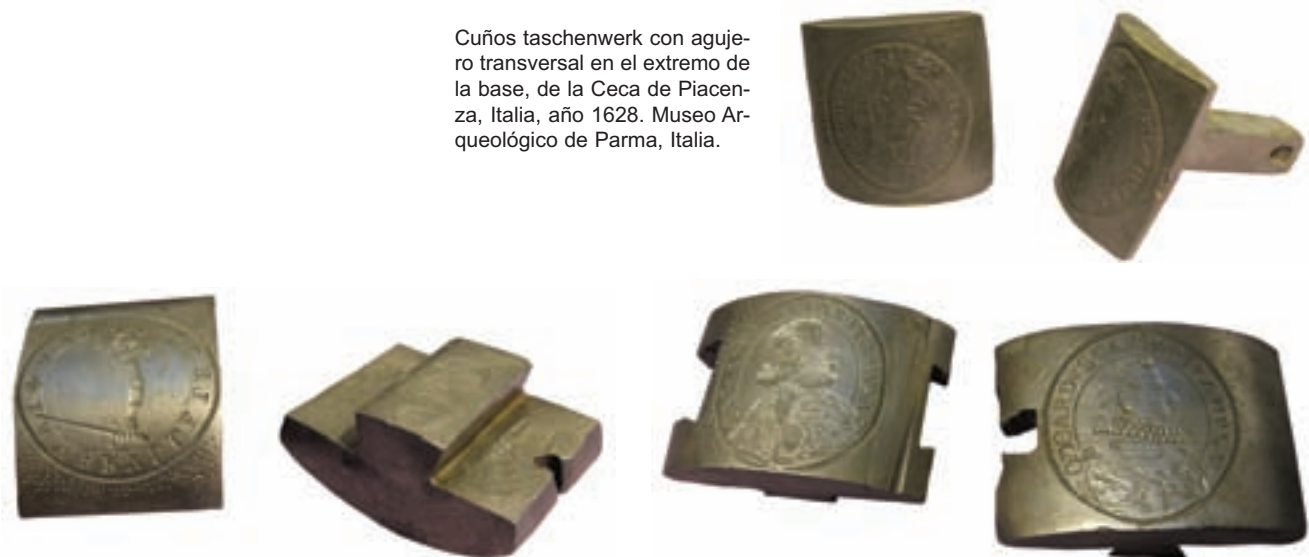
Extraños cuños procedentes de las Cecas de Parma y Piacenza, Italia, que corresponden a las décadas de 1670 y 1680, y al parecer se encajaban alrededor de un eje que giraba probablemente mediante una rueda hidráulica (arriba y abajo). Museo Arqueológico de Parma, Italia.
