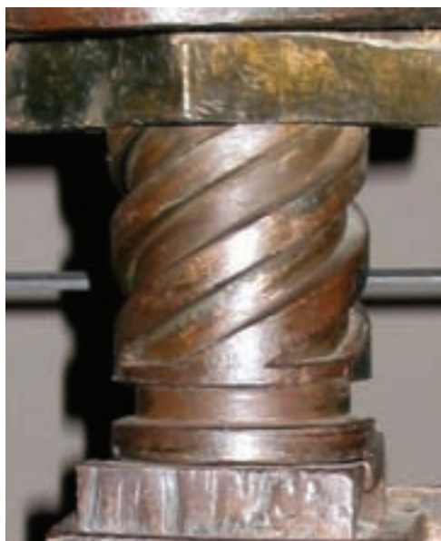
Tuerca de la prensa de volante de la Ceca de Pamplona, en el Museo de Navarra.
