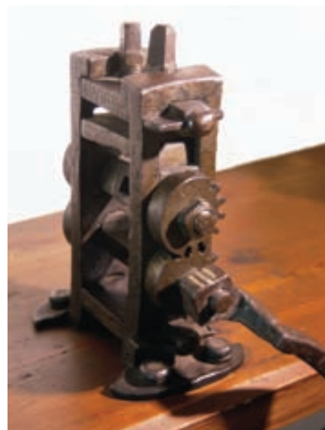
Prensa taschenwerk, sin cuños, procedente de la Ceca de Cesky Krumlov, Rep. Checa.
