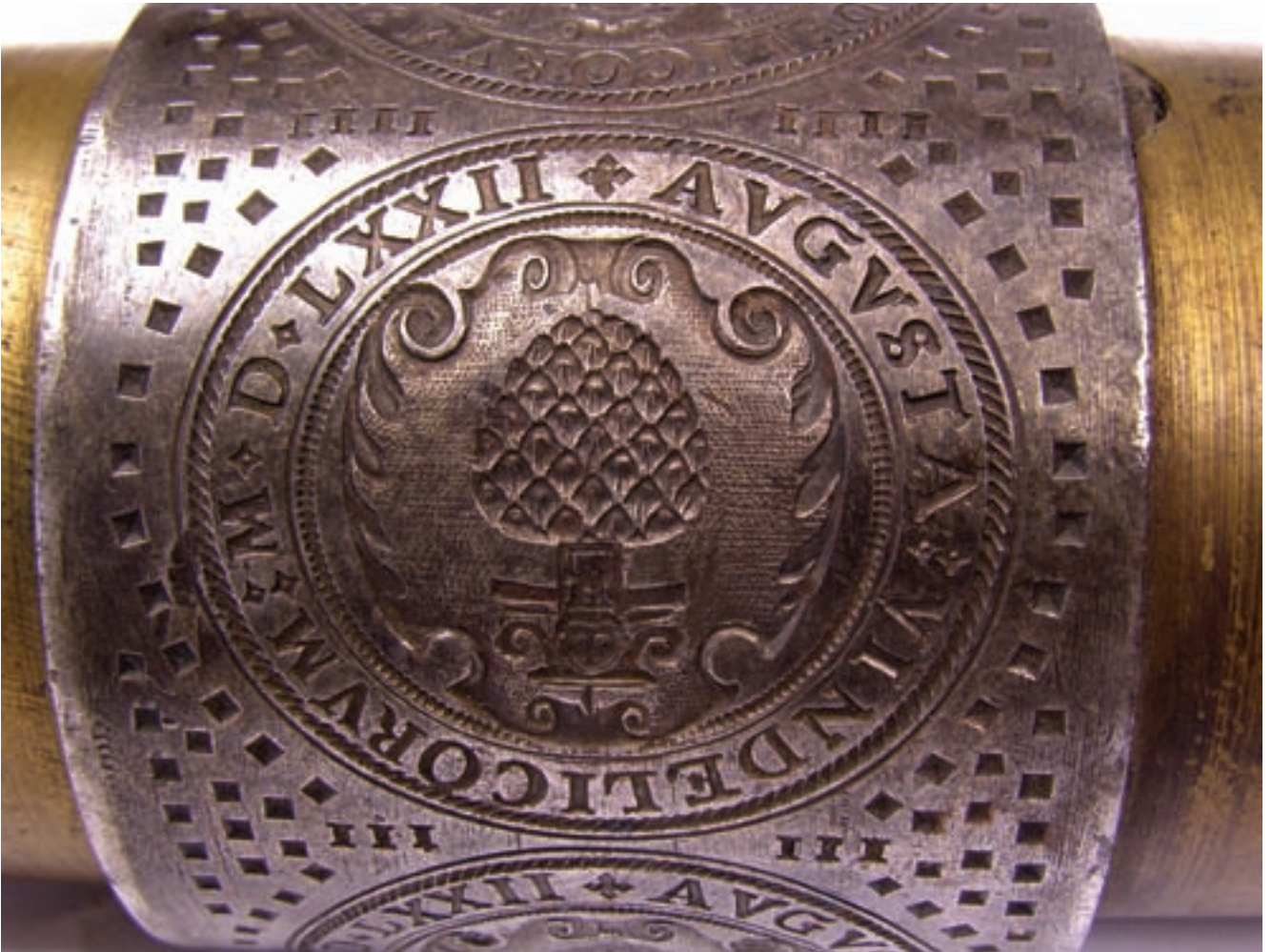
Foto y detalle ampliado e invertido del uno de los cinco cuños rodillos más antiguos conocidos. Procede de la Casa de Moneda de Augsburgo, del año 1572, como reza su leyenda: · AVGVSTA · VINDELICORVM · M · D · LXXII ·. Podríamos decir que es la muestra más antigua que existe de un instrumento de alta precisión para la fabricación masiva y mecánica de un producto industrial en serie, y de la cual su procedencia y año exacto de fabricación no quepa la menor duda.
