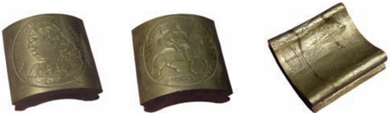
Extraños cuños procedentes de las Cecas de Parma y Piacenza, Italia, que corresponden a las décadas de 1670 y 1680, y al parecer se encajaban alrededor de un eje que giraba probablemente mediante una rueda hidráulica (arriba y abajo). Museo Arqueológico de Parma, Italia.
