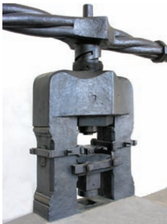
La prensa de volante de la Ceca de Núremberg, expuesto en el Germanisches National Museum, de dicha ciudad (izda.), es muy parecida a la de la Ceca de Gotha (arriba), pero mucho más grande.
